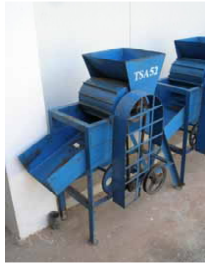
写真8 トマト採種器 (種子の入ったゼリー部を取り出す)
