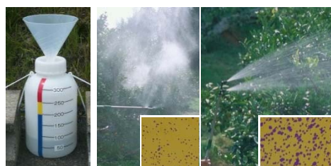
自作した散布適期判定雨量計の一例
