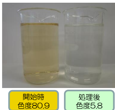
図2 微細気泡オゾンを利用した活性汚泥処理水の脱色状況
