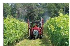
ワイナリー向け静電ブーム 適応垣根幅 摘芯機：1.8m前後～ 防除機：2m前後～
