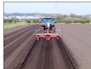
ステアリングの自動制御による直進走行
