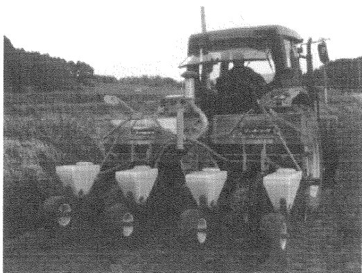
写真1 ジェットシーダー(JS4106 タカキタ社製)による播種 (指宿市 3月24日)
