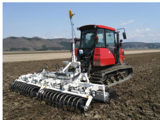
写真 対照機の均平作業（農試ほ場）
