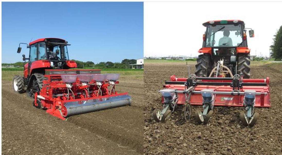
写真2. 現地実証試験の大豆播種作業 (左: 成形播種, 右: 平面播種)
