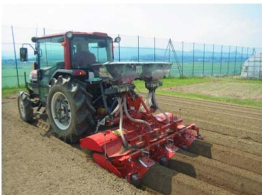
写真1 畦内局所施肥成形機によるうね内部分施肥作業
