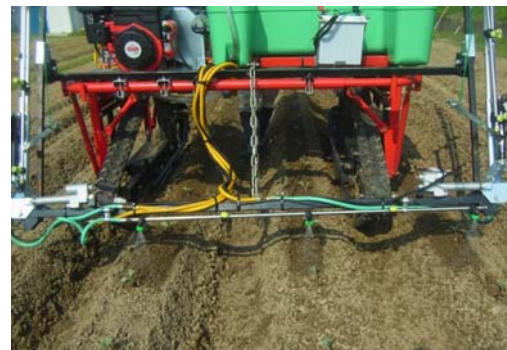
写真4 ブームスプレーヤによる灌水作業
