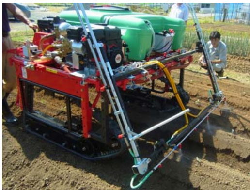
写真3 ブームスプレーヤによる灌水作業
