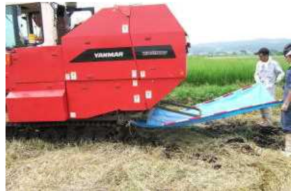
写真2 刈取成形時収穫ロス調査
