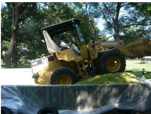
ショベルローダーでの踏圧作業
