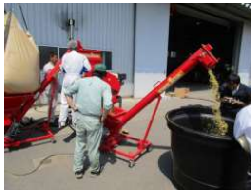
写真4 オオムギ SGS の破碎・調製作業
