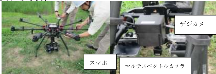
写真1：左 マルチコプター- 右 使用した3種類のカメラ
