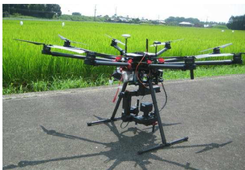
ドローン (NDVI測定カメラ搭載)
