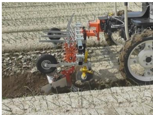
写真3 機械中耕除草(2月) (肩削りディスクあり)
