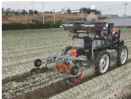
写真2 機械中耕除草(2月) (肩削りディスクなし)
