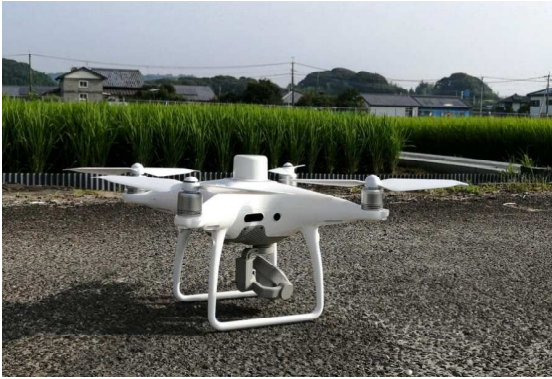
写真1 マルチスペクトルカメラ付ドローン (DJI社製:P4 MULTISPECTRAL)
