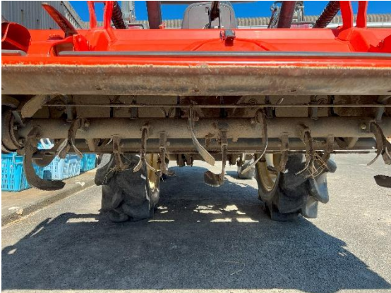
写真2 部分浅耕ロータリーと部分浅耕一工程播種作業のようす（播種機 AHT-40TDS）
