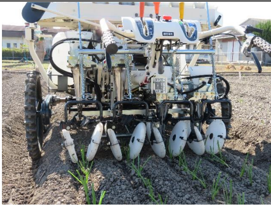
写真5 移植作業のようす (移植機 PH40RA)
