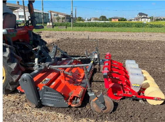
写真2 部分浅耕ロータリーと部分浅耕一工程播種作業のようす（播種機 AHT-40TDS）
